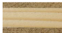
LAUBHOLZPLATTE MIT NADELHOLZ-MITTELLAGE
