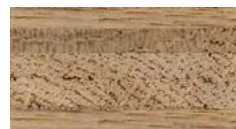
MÖBELPLATTE MIT 3-SCHICHT-MITTELLAGE
