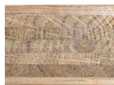
MÖBELPLATTE MIT 5-SCHICHT-MITTELLAGE
