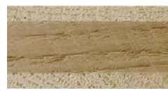
LAUBHOLZPLATTE MIT LAUBHOLZ-MITTELLAGE
