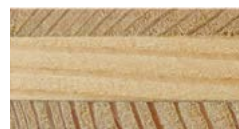
NADELHOLZPLATTE MIT NADELHOLZ-MITTELLAGE
