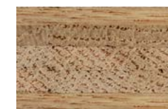
MÖBELPLATTE MIT 3-SCHICHT-MITTELLAGE
